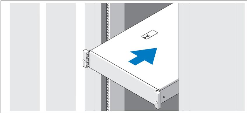
Monte los rieles e instale el sistema en el bastidor siguiendo las instrucciones de seguridad y de instalación del bastidor incluidas con el sistema.
