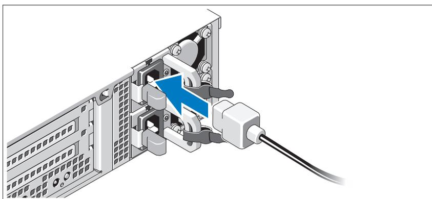
Conecte o(s) cabo(s) de alimentação ao sistema e, se for usado um monitor, conecte o cabo de alimentação do monitor.
