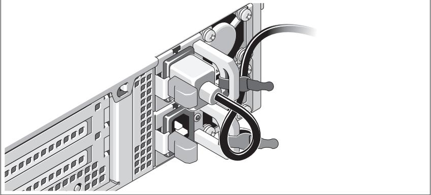
Faites une boucle comme indiqué dans l'illustration, puis fixez le câble à l'aide de la sangle fournie. Branchez ensuite l'autre extrémité du câble d'alimentation sur une prise secteur mise à la terre ou sur une autre source d'alimentation telle qu'un onduleur (UPS) ou une unité de distribution de l'alimentation (PDU).
